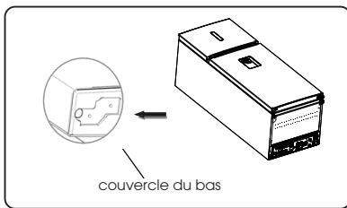
2. Mettez la vis dans le trou du tampon de support en caoutchouc.
