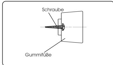
3. Richten Sie die Schraube auf das Loch auf der unteren Sockelblende. Befestigen Sie die Gummifüße mit einem Kreuzschlitzschraubendreher (selbsterstellte) fest an der Sockelblende.
