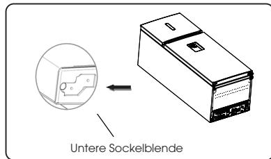
2. Setzen Sie die Schraube in das Loch der Gummifüße.
