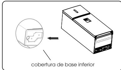
2. Coloque o parafuso no orifício do suporte de borracha.
