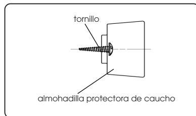
3. Alinee el tornillo con el orificio del cobertor inferior de la base. Coloque firmemente la almohadilla protectora de caucho en el cobertor de la base utilizando un destornillador (autosuministrado).
