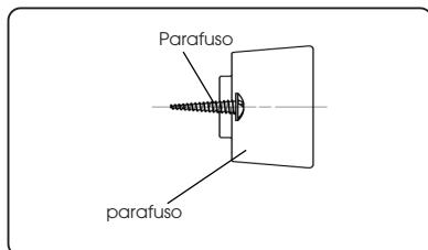
3. Alinhe o parafuso com o orifício na tampa inferior da base. Prenda firmemente a placa de suporte de borracha na tampa da base com uma chave de fenda cruzada (fornecida por usuário).
