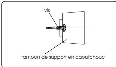
3. Alignez la vis avec le trou sur la couverture de base inférieure. Fixez le tampon de support en caoutchouc à la couverture de base fermement par un tournevis cruciforme (fourni par vous-même).
