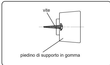
3. Allineare la vite al foro presente sulla copertura della base inferiore. Fissare il piedino di supporto in gomma alla copertura della base con un cacciavite a croce (non in dotazione).
