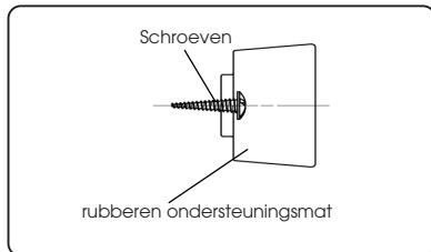
3. De schroef uitleiden op het gat op de onderste bodemdeksel. Bevestig de rubberen ondersteuningsmat stevig op de bodemdeksel met een kruiskopschroevendraaier (zelf aan te schaffen).
